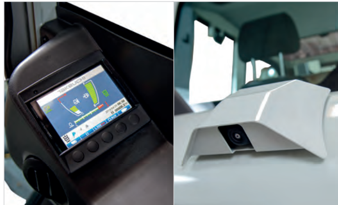
Neues, kratzfestes Display aus anlaufresistentem Verbundglas, sowie ein Werkstattmenü mit neuen Funktionen. Einblendung der Rückfahrkamera erfolgt automatisch.
