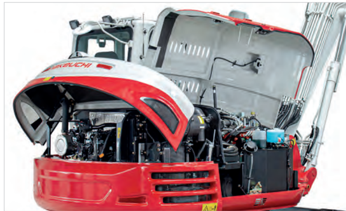
Großzügige Wartungskappen für servicefreundlichen Zugang zu Motor und Hydraulikaggregaten.
